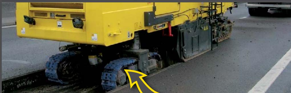
**ZAPATAS DE POLIURETANO ESPECIALMENTE INDICADAS PARA FRESADORAS DE ASFALTO**
